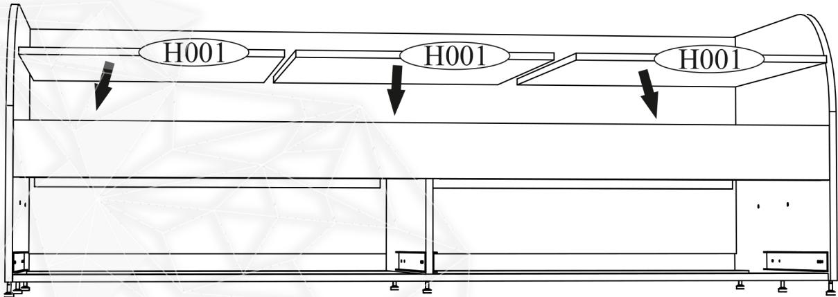
Для укрепления конструкции рекомендуем прикрутить настилы к планкам с помощью шурупов 4x30.
